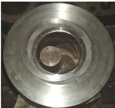
Рис. 5. Разрушение матрицы
