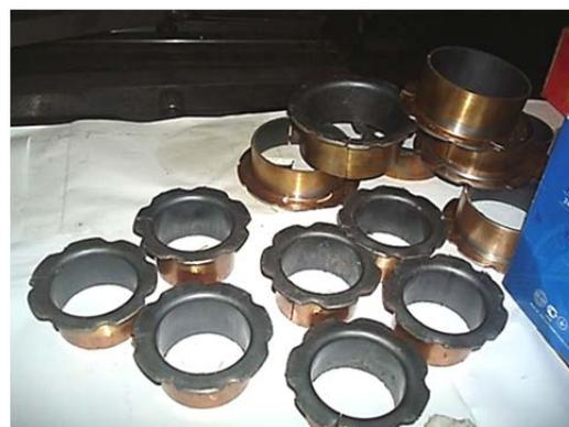
Рис. 8. Фланец заготовки, полученный в результате моделирования и натурального эксперимента
